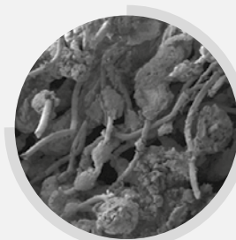
Gąbka używana - rozpadająca się siatka włókien z wychwyconym brudem
